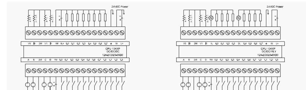
UN 124-2CD23-0XB0 wiring diagram
