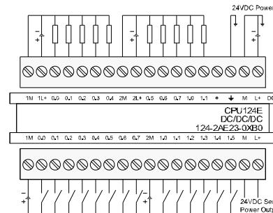
UN124-2AE23-0XB0 wiring diagram
