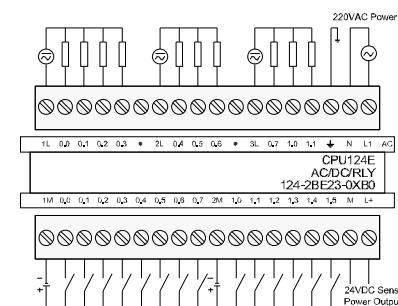
UN124-2BE23-0XB0 wiring diagram
