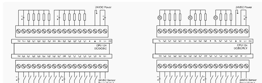
UN124-1AD23-0XB0, UN124-2AD23-0XB0 wiring diagram
